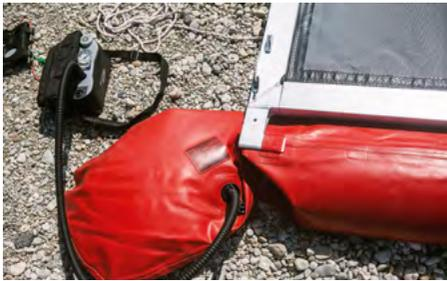
Den Druck liefert eine Elektropumpe, der Alurahmen ist nur in Laschen eingesteckt
