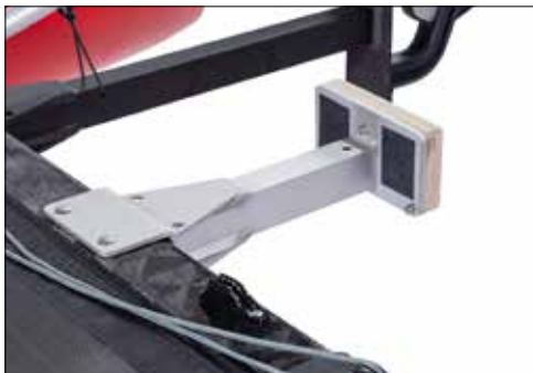
Langschacht-Motor: lange Seite nach oben Long shaft motor: long side up
