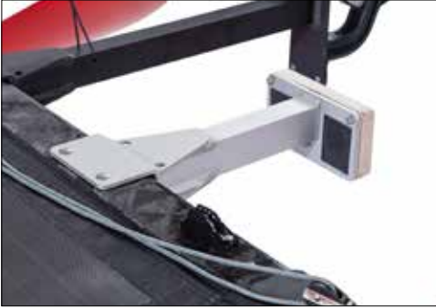
Kurzschaft-Motor: kurze Seite nach oben Short shaft motor: short side up
