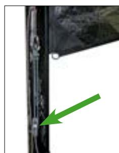
**NOTA IMPORTANTE:** La vela de proa debe estar bien tensada. La tensión debe estar en el grátil y no en el estay. De este modo, todo el sistema (sables, cables tensores, grátil) queda correctamente tensado.
