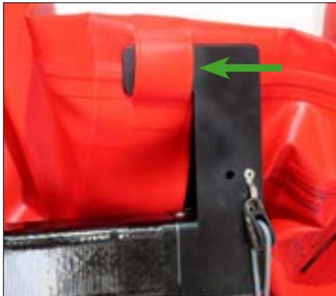
**NOTA: Ad ogni angolo del telaio ci sono due fissaggi: 1 sulla parte superiore e 1 nella parte interna.**
