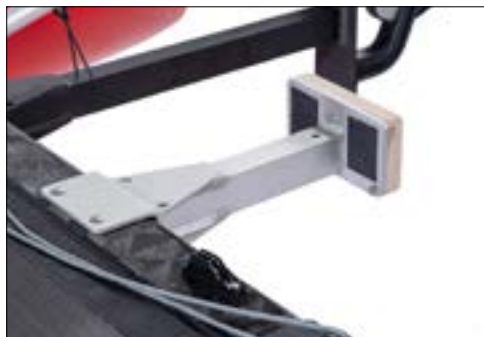
Moteur à tige longue : côté long vers le haut Long shaft motor: long side up
