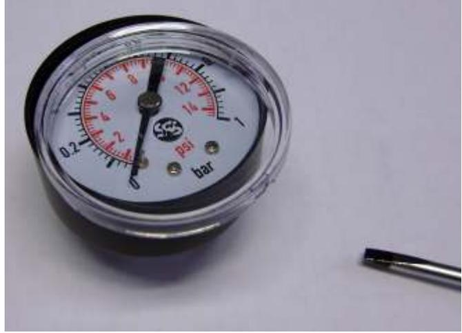
Heben Sie das Glas vom Manometer ab, indem Sie einen Schlitz-Schraubendreher in die Vertiefung im Glas stecken und drehen. Nehmen Sie das Glas ab.
