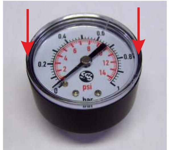
Setzen Sie den Zeiger bei Null wieder ein und drücken Sie das Glas auf den Manometer.
