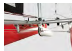
Câbles de sous tension
